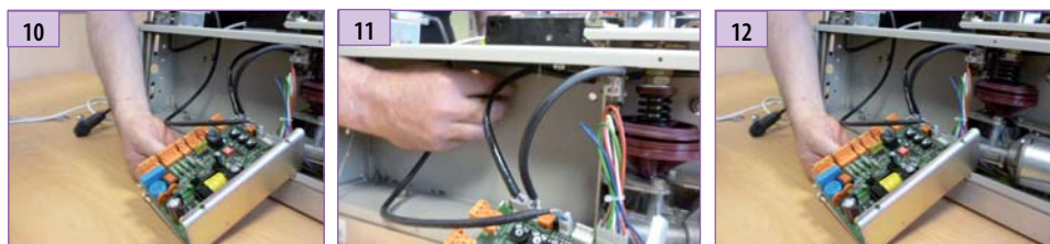
Déposer la platine et visser le 2e écrou
